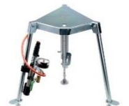
簡易平板載荷試験(エレフット)
