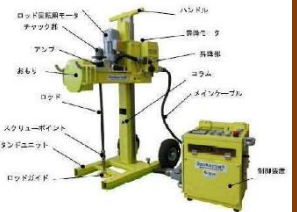
スクリードライバースクランディング試験(SDS試験)
